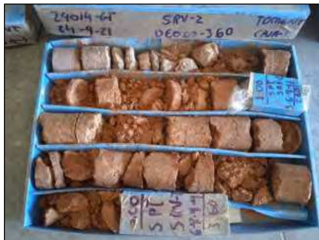
Fotografía 2.- Sondeo 2, caja de 0.00 a 3.60 m
