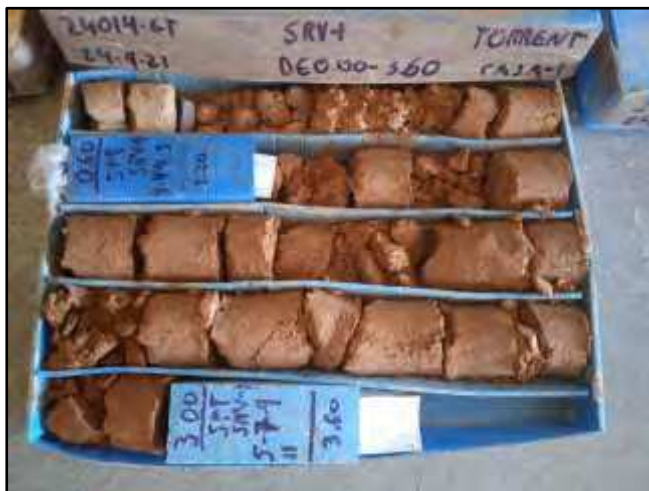
Fotografía 1.- Sondeo 1, caja de 0.00 a 3.60 m
